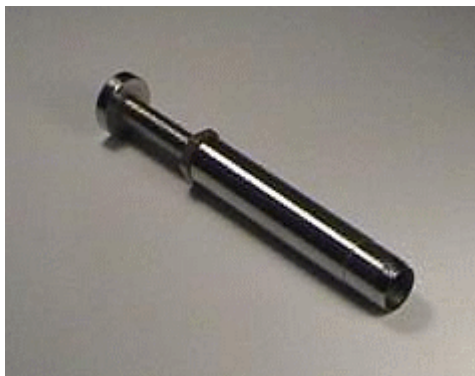
Rys. 1. Przyrząd do wycinania walcowych próbek.
