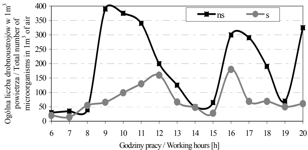
Produkcja: s - stabilna, ns - niestabilna mleka pasteryzowanego (zgodnie z analogicznym harmonogramem produkcji, ale inną organizacją pracy załogi) / Pasteurized milk production process: s - stable, ns - unstable (according to analogical production harmonogram, but with different work organization).
